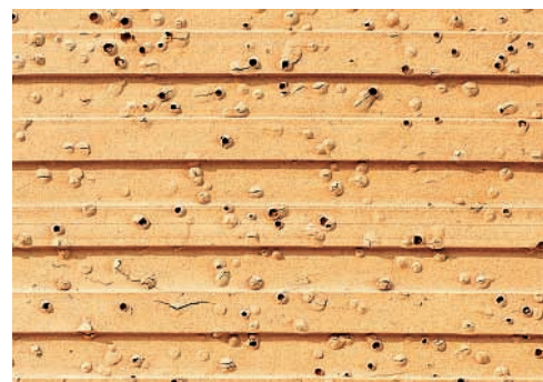
Fig. 2 Il particolare aspetto della superficie di un laterizio a massa alveolata è prodotto dall'inclusione di piccole cavità diffuse nella massa del materiale, che aumentano l'isolamento termico.
