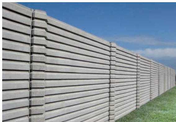
Fig. 3 Recinzione realizzata con montanti a sezione esagonale e pannelli di calcestruzzo componibili in altezza.
